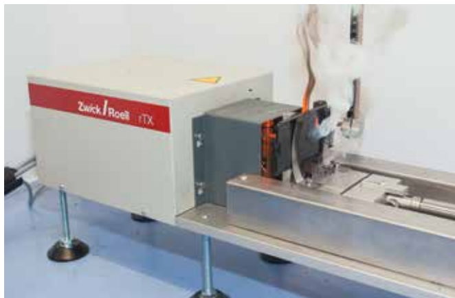
Рис. 6. Метод «раскаленной иглы» помогает проверить огнестойкость и пожаростойкость полимерного изделия
