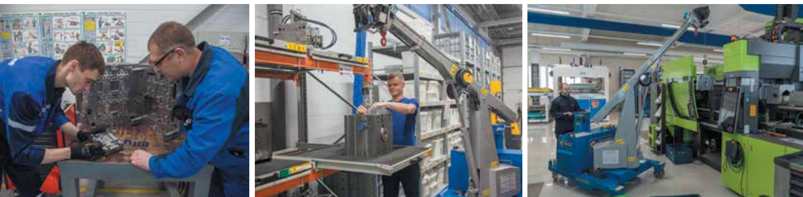
Рис. 7. Формообразующие вставки в формы требуют бережного отношения и контроля их состояния (а), а сами формы – надлежащего обращения с ними как при складировании (б), так и при монтаже на литьевой машине (в)
