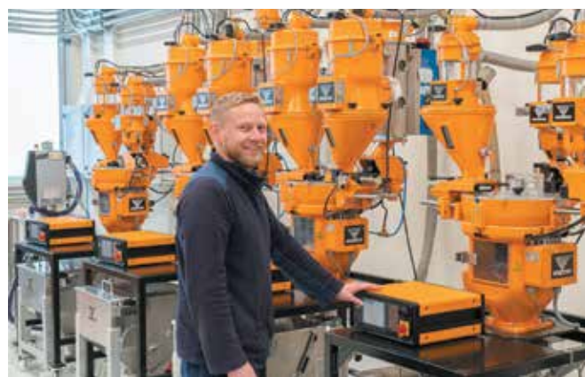
Рис. 3. Автоматизированная модульная кросс-система сушки, гравиметрического дозирования и загрузки сырья от компании Koch-Tecnik (Германия)
