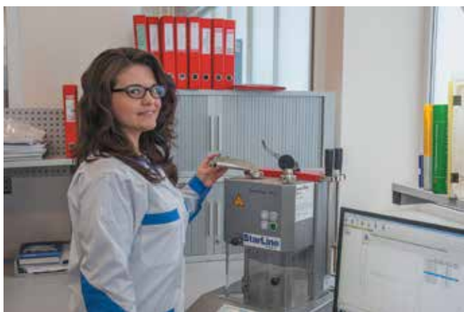
Рис. 5. Пластометр Zwick Mflow в испытательном центре НПО «СтарЛайн»
