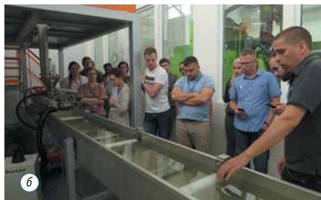
Рис. 4. Компаундер модели ZSE 27 MAXX (а) и линия на его основе с ванной подводного гранулирования (б)
