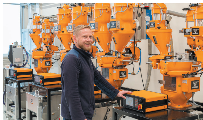
Рис. 3. Автоматизированная модульная кросс-система сушки, гравиметрического дозирования и загрузки сырья от компании Koch-Tecnik (Германия)
