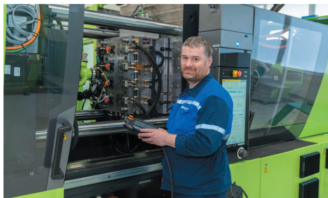
Рис. 1. Парк имеющихся в НПО «СтарЛайн» литьевых машин компании ENGEL позволяет изготавливать как одно-, так и многокомпонентные полимерные изделия, в том числе с закладными элементами
